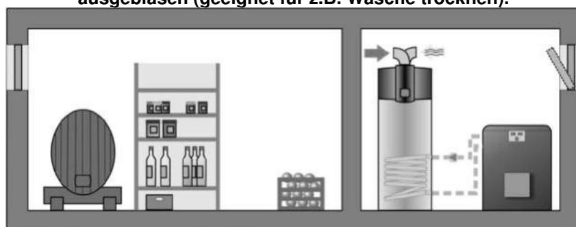
Abbildung 2: Die Luft wird aus demselben Raum abgesaugt und in denselben Raum ausgeblasen.
