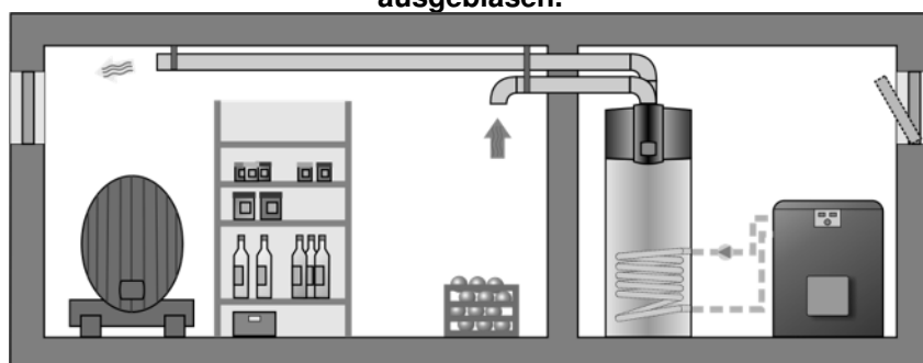
Abbildung 3: Die Luft wird aus dem benachbarten Raum abgesaugt und in denselben Raum ausgeblasen (geeignet für z.B. Kühlung des Raumes).
